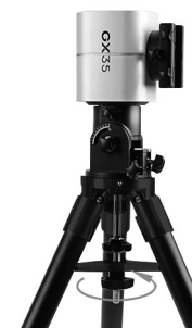
1.2.3 拧出中心拉杆下面的螺母，取出垫片。将附件盘插入中心拉杆，三个翼尖对准架腿，装入垫片，适度拧紧前面拧出的螺母。
