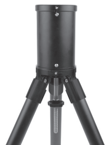
1.3.4 拧出中心拉杆下面的螺母，取出垫片。
