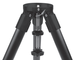
1.3.1 松开三脚架侧面的固定螺丝。
