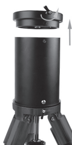
1.3.6 用标配的较小扳手拧出延长管上面的三颗螺丝，取出连接座。松开连接座侧面的额固定螺丝。
