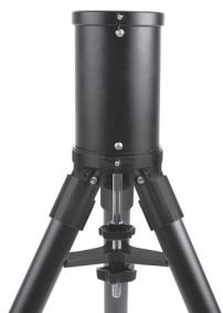
1.3.5 将附件盘插入中心拉杆，三个翼尖对准架腿，装入垫片，适度拧紧 1.3.4 拧出的螺母。
